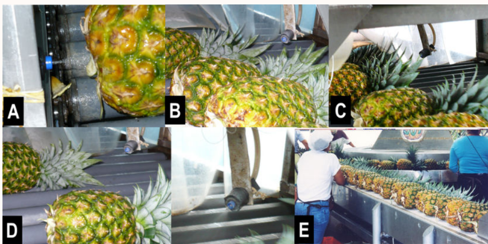
Figura 24. Sistema de tratamiento postcosecha mediante boquillas de aspersión: A) boquillas situadas para el tratamiento de la base de los frutos para el control de la pudrición del tallo; B, C y D) boquillas situadas para la aspersión de las coronas. E) ubicación de la fruta para su tratamiento (Fotos: Luis Pérez Vicente).
