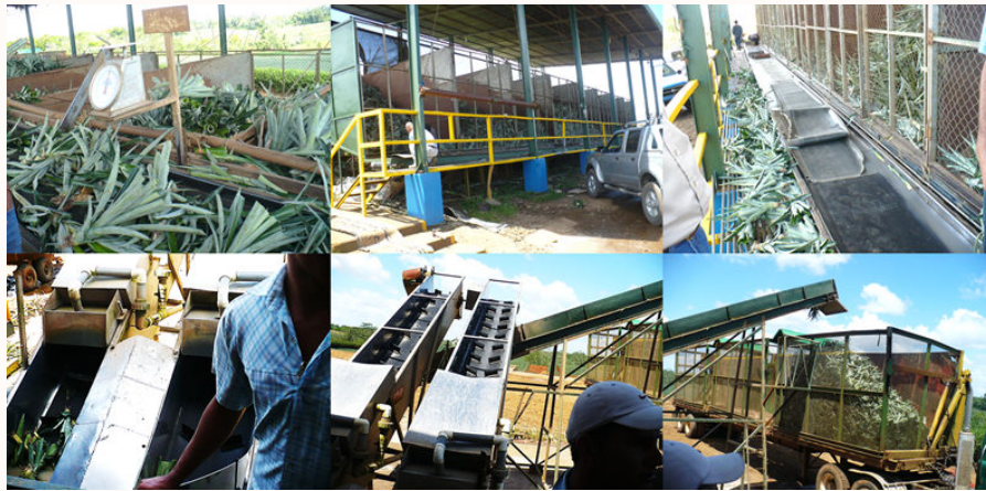
Figura 21. Planta de tratamiento de semillas en la Empresa Agramonte en San Carlos, C. Rica. De derecha a izquierda: Clasificación de hijos por peso y almacenaje por separado; estera para conducir a baños de tratamiento; estera elevadora para el descargue a las carretas para conducir las al campo (Fotos: Luis Pérez Vicente).
